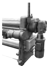
Napęd walca górnego, wyłącznik awaryjny i silnik z hamulcem
