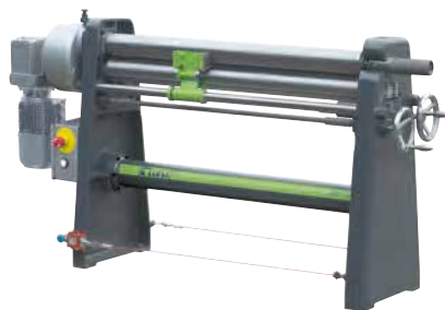
Napęd walca górnego, wyłącznik awaryjny i silnik z hamulcem
